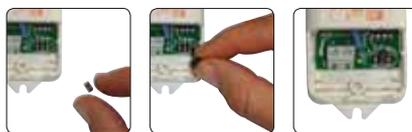
Fornito di JUMPER per la selezione della corrente in uscita
